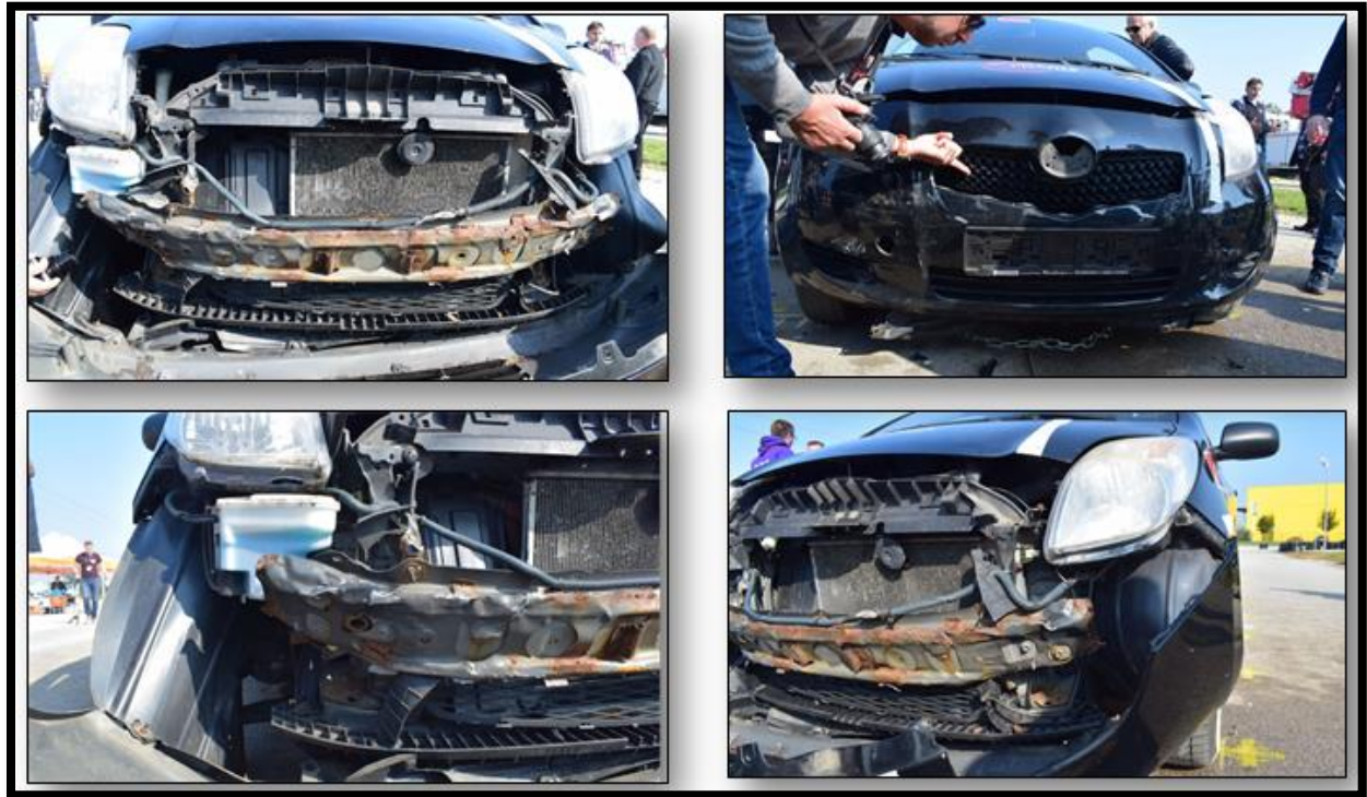
Sl. 6 do 9 - Oštećenja na Toyoti
