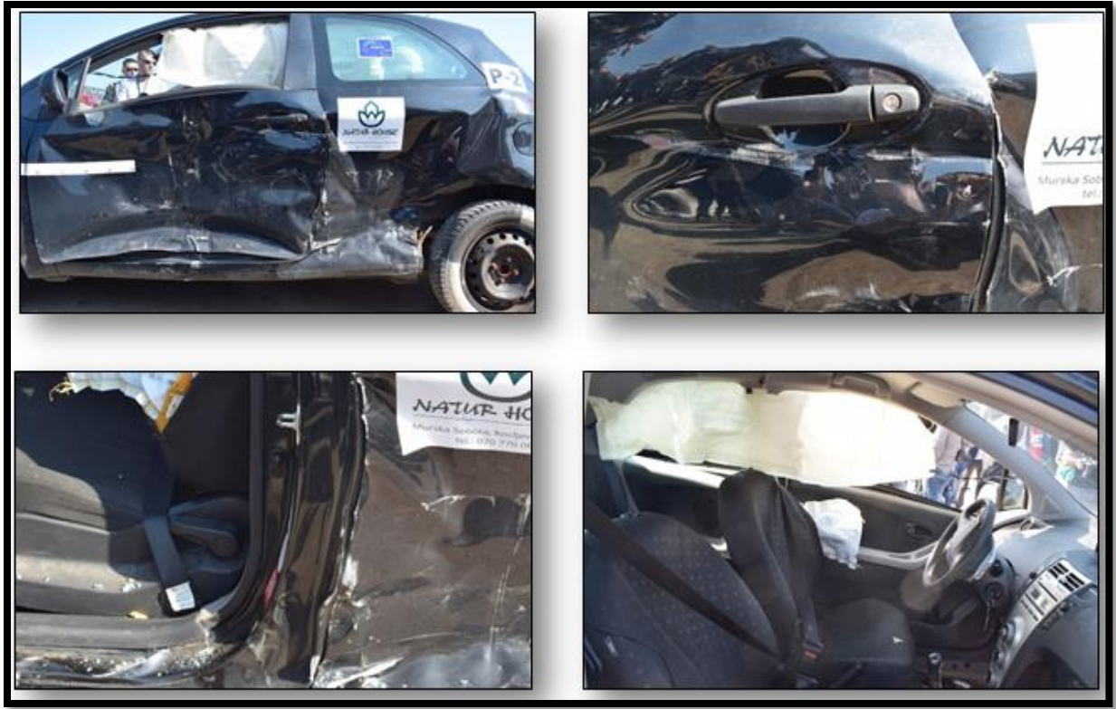
Sl. 10 do 13 - Oštećenja na Mazdi
