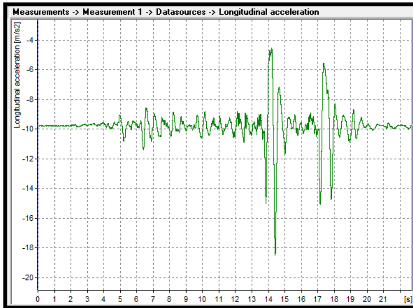
Sl. 12 – Izmerena VERTIKALNA usporenja autobusa (smer ka centru N S)
