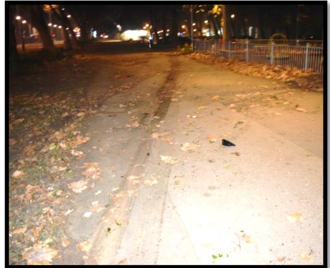
Sl. 4 - Trag rasipanja fluida (ulje) i sa obe strane tragova kretanja vozila na trotoaru
