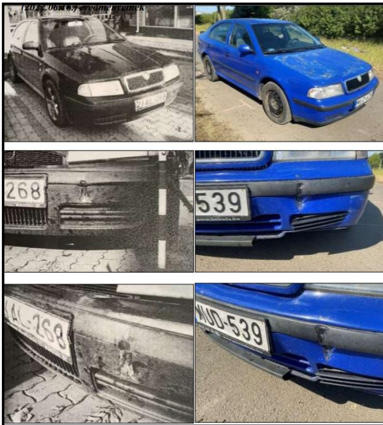
Slika 10 - Oštećenja na Škodi (leva kolona izvorna, desna kolona eksperiment)
