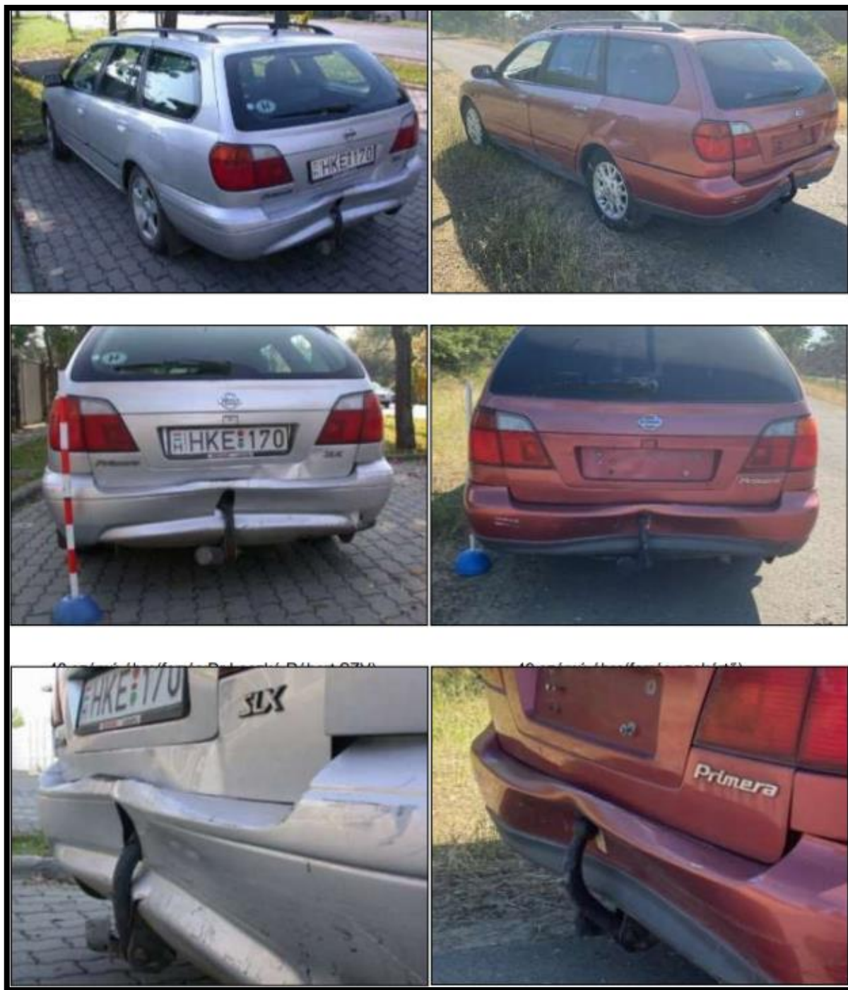
Slika 11 - Oštećenja na Nissanu (leva kolona izvorna, desna kolona eksperiment)
