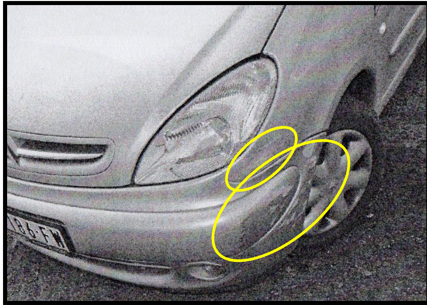
Sl. 10 – Oštećenja na Citroenu
